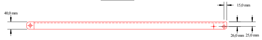
Jambe de sécurisation
